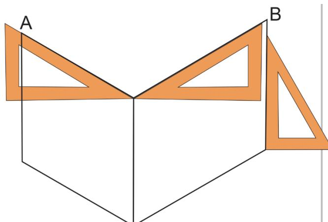
1. por los puntos A y B trazar líneas a  $30^\circ$ , paralelas a los ejes correspondientes, con lo cual se forma el plano isométrico
