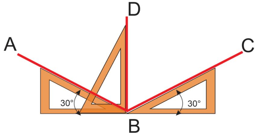
La intersección de tres caras principales de un cubo da origen a los llamados ejes o aristas principales del mismo. En el dibujo isométrico estos ejes reciben el nombre de Ejes Isométricos y se cortan formando tres ángulos iguales entre sí ( $120^\circ$ ).
