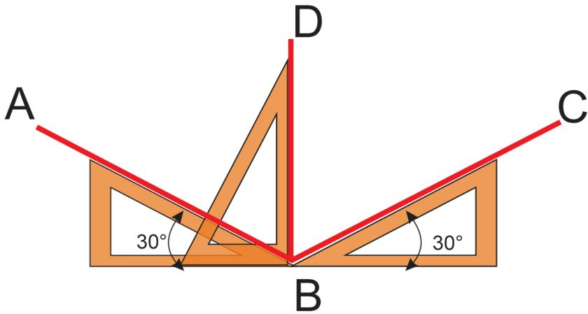
La intersección de tres caras principales de un cubo dan origen a los llamados ejes o aristas principales del mismo. En el dibujo isométrico estos ejes reciben el nombre de Ejes Isométricos y se cortan formando tres ángulos iguales entre sí ( $120^\circ$ ).
