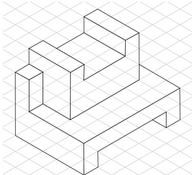
La elaboración de un Dibujo Isométrico exige pensar que realmente construye la pieza retirando las partes por cortes sucesivos del material utilizado. Con base en lo anterior se parte del principio que toda pieza, por complicada que sea, tiene su origen en un paralelepípedo rectángulo o caja isométrica de dimensiones iguales a las totales del objeto.
