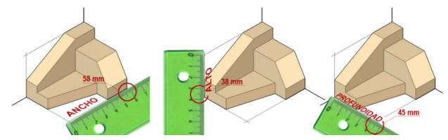
Tengo las tres medidas para empezar a realizar las operaciones para distribuir las piezas en la lámina. Las medidas son: ancho = 58 mm, alto = 38 mm y profundidad = 45 mm.
