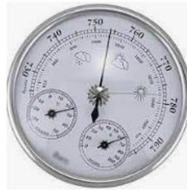
El barómetro es el instrumento que mide la presión del aire. Contiene un tambor con paredes flexibles y se puede estirar como un fuelle. Cuando el tambor del barómetro se estira significa que la presión está bajando. Por el contrario, un tambor encogiéndose, indica que la presión está subiendo.
